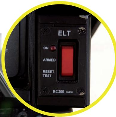
← La balise de détresse s'enclenche automatiquement en cas de choc mais si nécessaire, il y a la possibilité d'allumer manuellement la balise en basculant l'interrupteur ELT sur ON. L'interrupteur se trouve sur le tableau de bord à des endroits différents en fonction du type de machine et son emplacement vous sera expliqué par le pilote.
